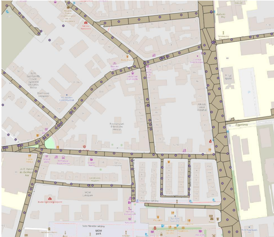
4. ábra - Lehatárolt utak és burkolt felületek, és ezek víznyelőhöz rendelése Thiessen poligonok segítségével
