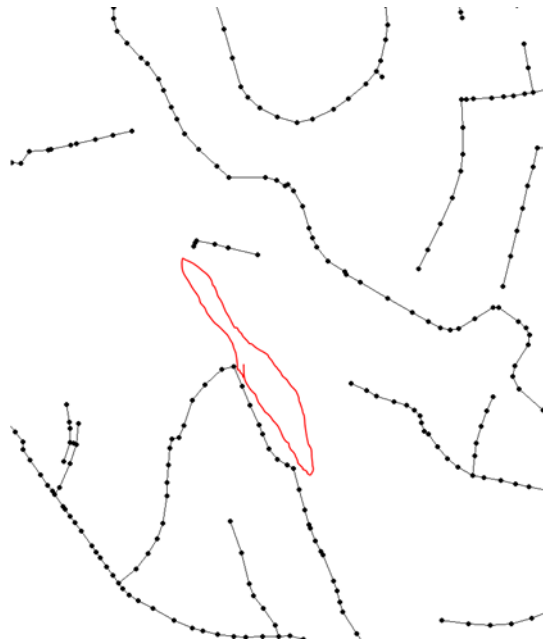
1. ábra – Példa hiányzó csatornaszakaszra
