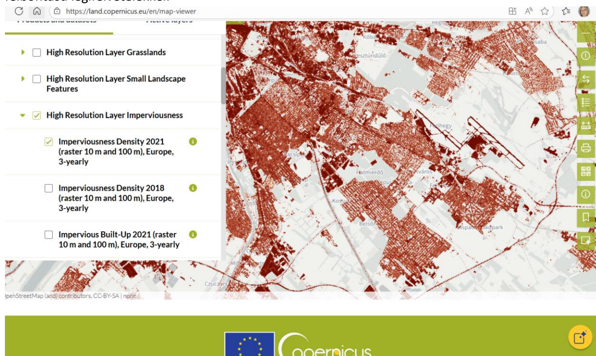
34. ábra Vízzáró felületek elhelyezkedése 10méteres raszteres felbontású raszterből előállítva
